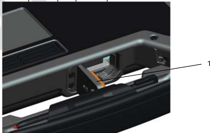
1 Sportello per Secure Digital nella propria posizione aperta
