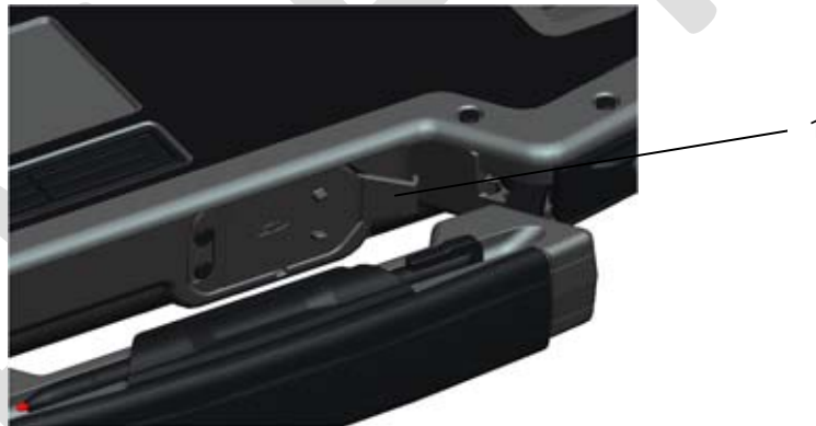
1 Maniglia dello sportello per Secure Digital nella posizione estesa
